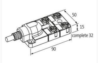
M12-Females 5-pole 5 (PE 4 (N/O)-(ST) 3(-) 2 (N/C)-(52) 1441 ye/bu white green n/ye rowr fue i/pk ť peu n.c. n.c. free arrangeable, contact 1:1 on terminals for 4 signals per port, PIN5 bridged on terminals
